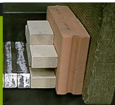
Ізоляційні та футеровочні матеріали котла і камери
