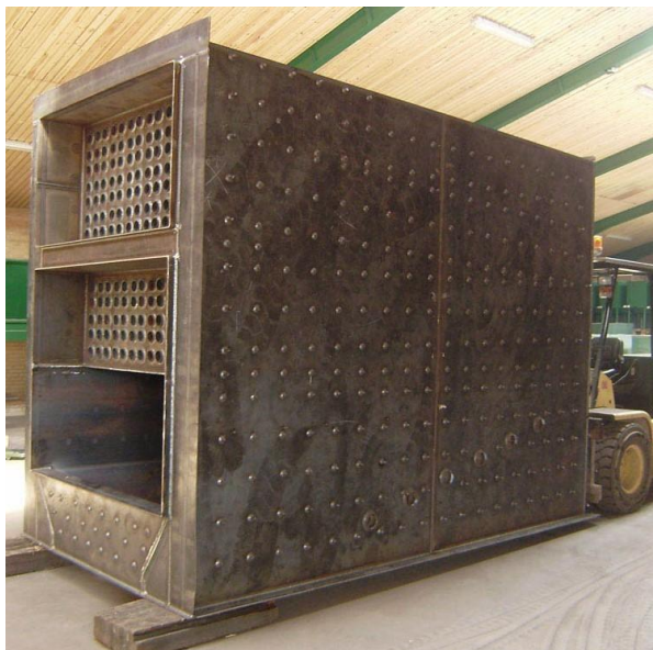
Будівництво котла НКRST 2,8 МВт
