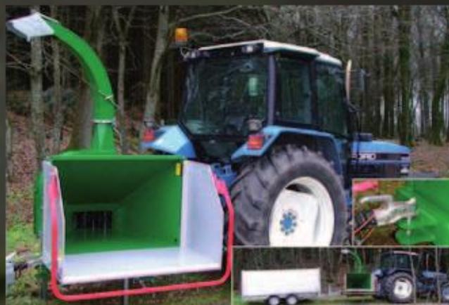
NHS 180 v - угловая машина на BOM трактора. Оснащена прицепным устройством для небольшого прицепа сзади машины.
