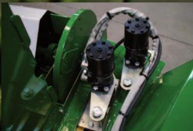
2 мощных гидравлических двигателя обеспечивают сильную и надёжную загрузку.
