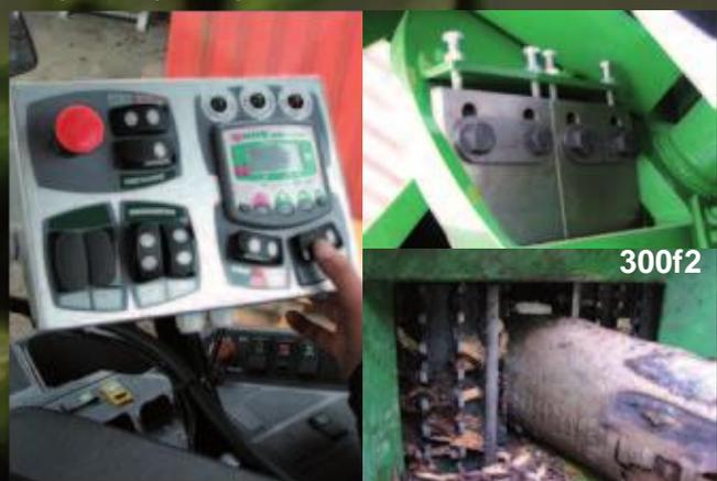
Блок управления машин «лесной линии». Сплит ножи для оптимального операционного процесса. Агрессивные вертикально-подающие ролики.
