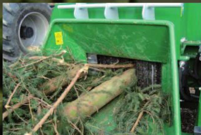
Механизм подачи с агрессивными вертикальными роликами достойны признания мирового класса.
