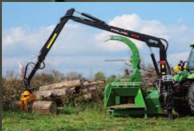
NHS 300icv - машина с загрузкой при помощи крана под углом 90°
