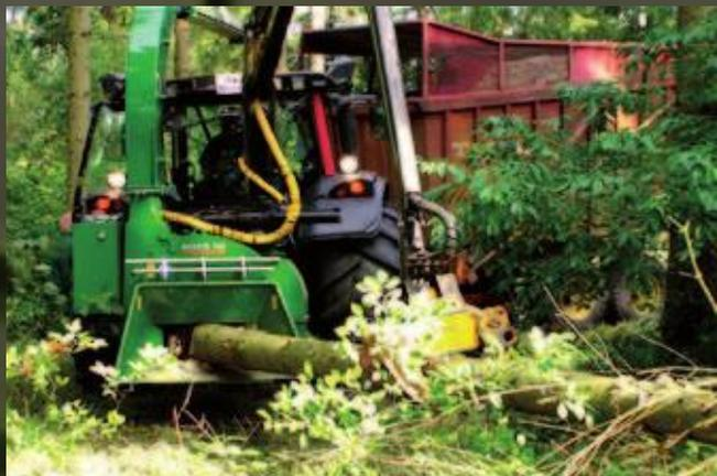
Пример NHS 300F, показан с XL трубой для выброса щепы. Дробилка сзади, прицеп - спереди трактора
