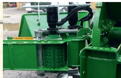
Den hængslede indtrækskasse giver optimale forhold for servicering af knive og modstål.
