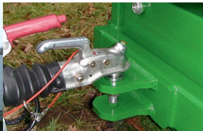
V-serien har alle påhængstræk for let tipvogn eller lignende (max. kugletryk: 500 kg. / max. træk: 2000 kg.)
