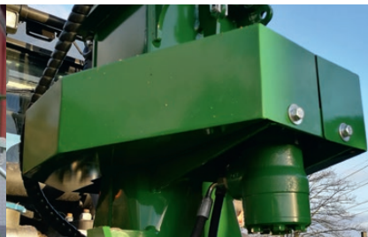
Med NHS AutoTurn justeres afgangstudens og dermed flis-strålens retning let og bekvemt.
