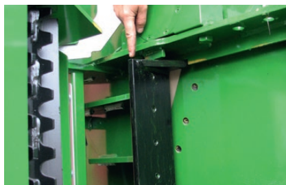
Den hængslede indtrækskasse giver optimal adgang til knive og modstål for servicering.
