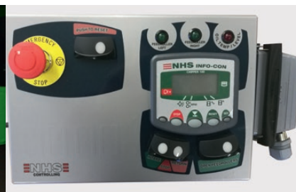
Al betjening og elektronik er samlet i styreboksen, der skånsomt og sikkert er placeret i traktorens kabine.
