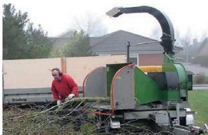
Undervogn med dobbelt aksel stabiliserer maskinen i terræn og ved vejtransport.
