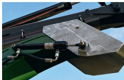
Med NHS AutoTurn er flisstrålen let at styre mod den efterhængte vogn (Option).
