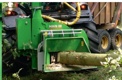
Med NHS AutoOpen lettes indføring af stammer i max. størrelse.
