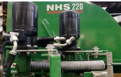
Direkte, hydraulisk træk på begge valser øger effektivitet og reducerer antal af slid- og reservedele.
