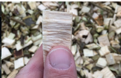
En snit-vinkel på 80 grader gør flisen regulær og mindsker stikkere (her vist fra RoughCut).
