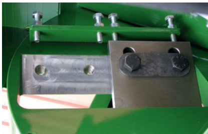
Delte knive optimerer driftsomkostningerne.
