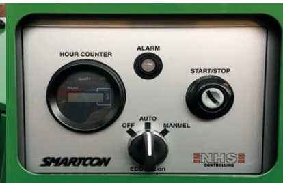
NHS-SmartCon - Auto opstart/nedlukning, Anti-stress, timetæller, indtræk start/stop, EcoMotion dvale-funktion og meget mere
