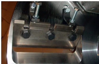
Trinløs justering af knive sikrer bl.a. god og ensartet flis.
