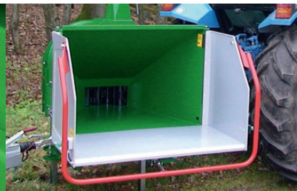
Side-indmadning er optimalt ved oprydning langs rabat og vejside.
