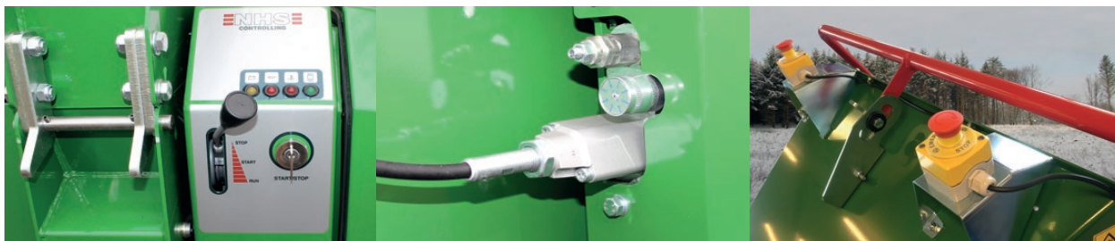
Simpel opstart - Gi gas til start mærke, drej nøglen, giv fuld gas og du er klar til at arbejde
