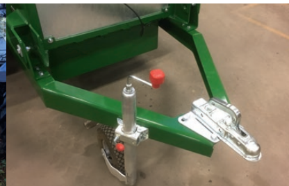
Programmet for ekstraudstyr er bredt - her hjulsæt med Ø50mm kugletræk.
